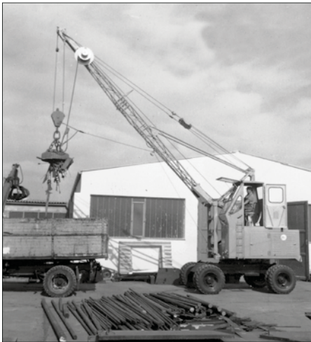
1962: Seilbetriebener S833 mit erhöhter Fahrerkabine
