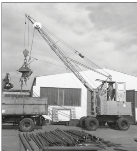
1962: Seilbetriebener S833 mit erhöhter Fahrerkabine
