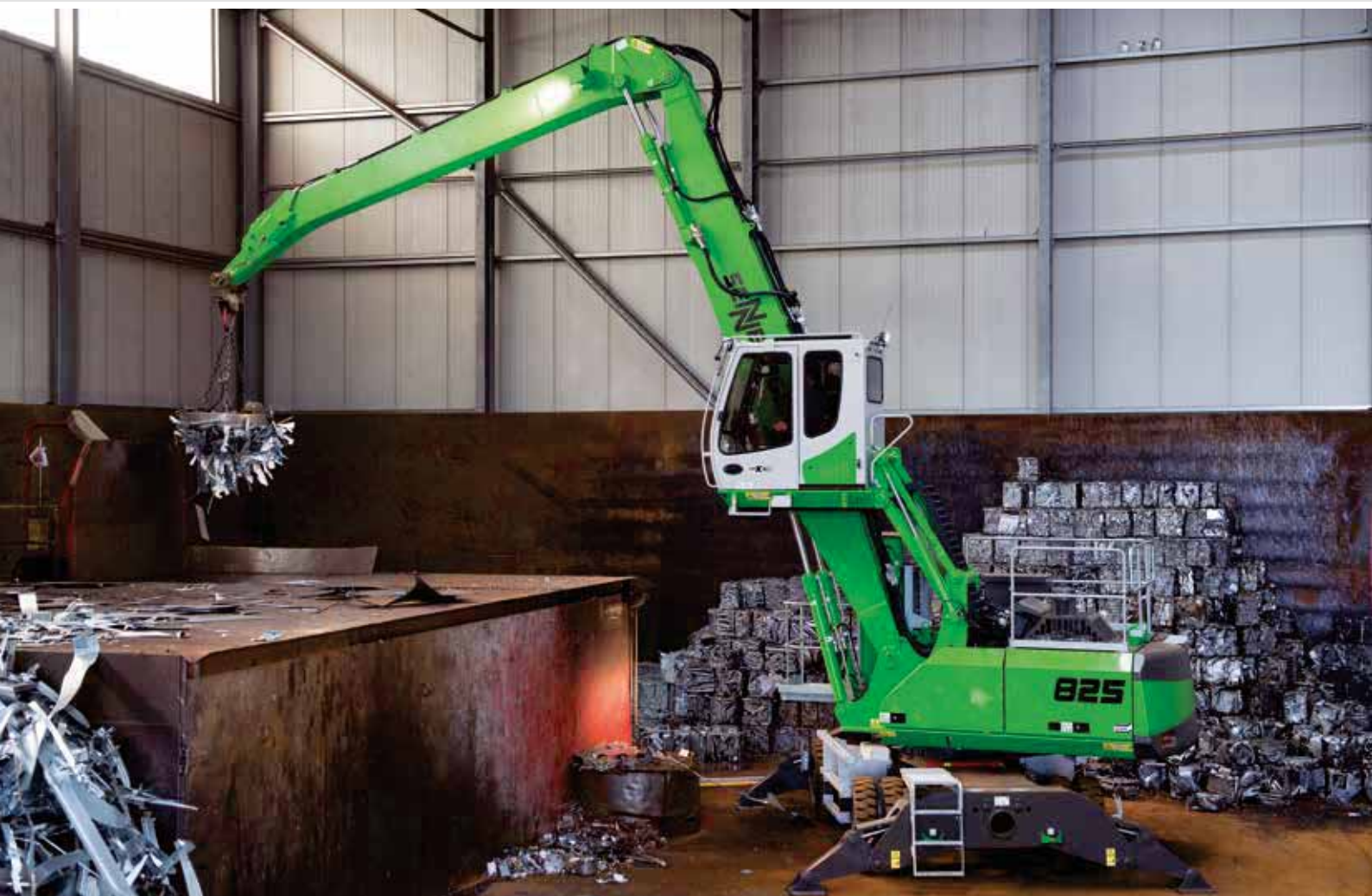
18 825 M - Schrottumschlag mit Magnetplatte; Deutschland
