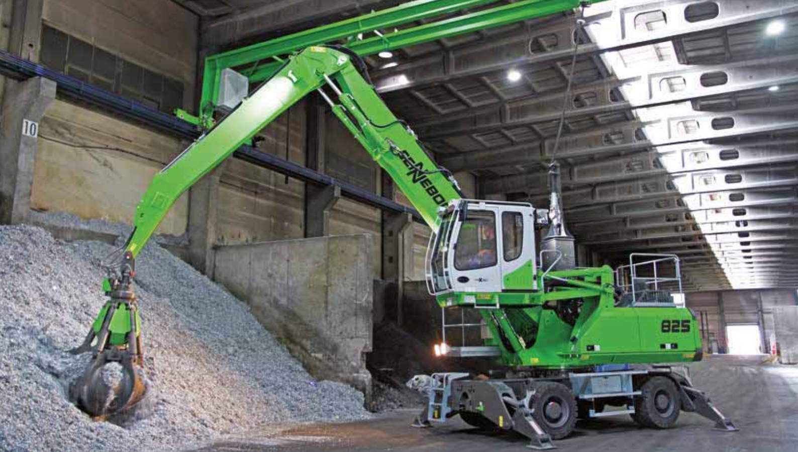
825 M Elektro - Schrottoumschlag in der Halle mit Deckenstromversorgung; Deutschland
