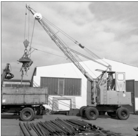
1962: Seilbetriebener S833 mit erhöhter Fahrerkabine
