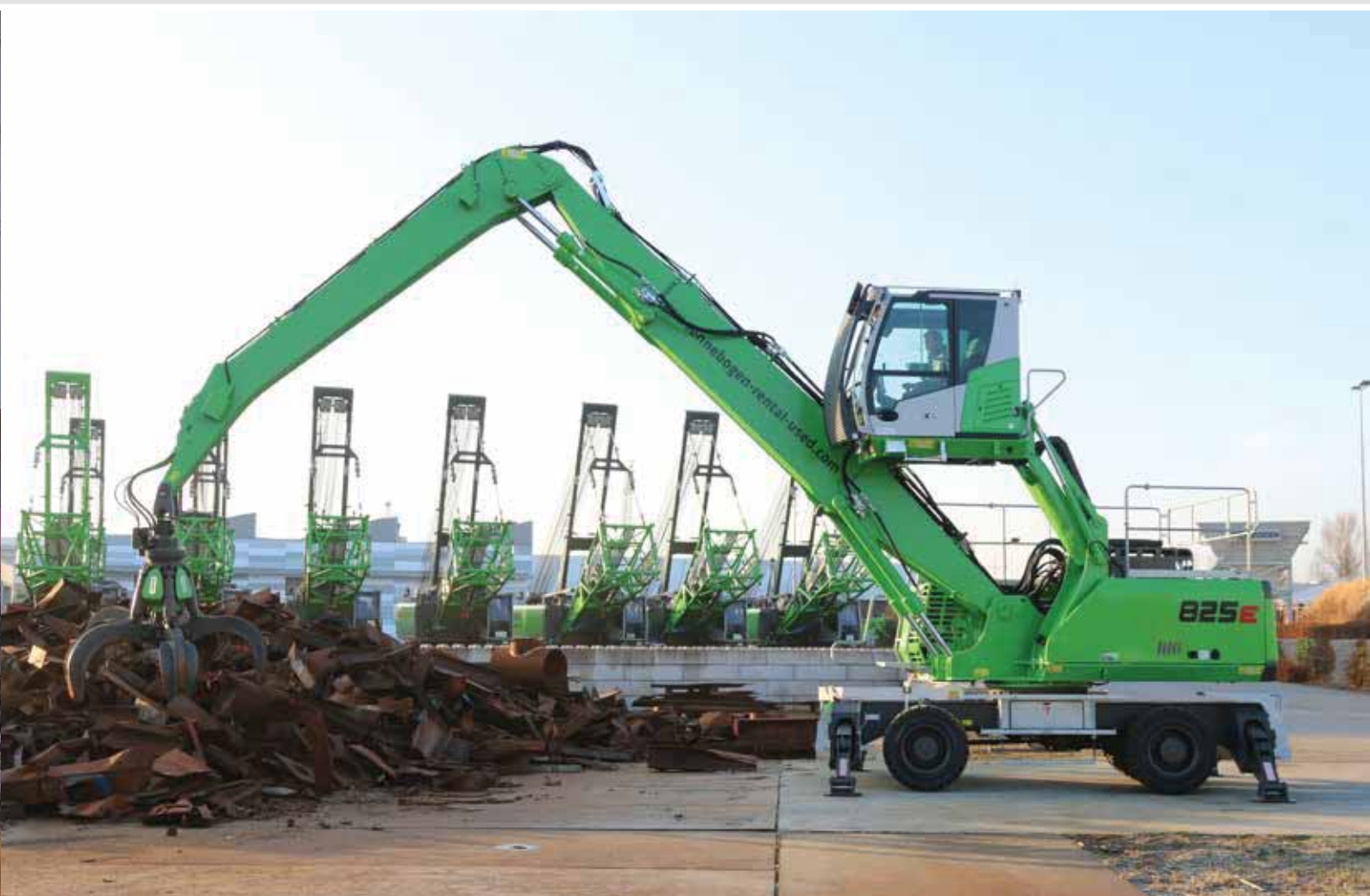
825 M -Mobiler Schrottoumschlag mit original SENNEBOGEN Mehrschalengreifer; Deutschland
