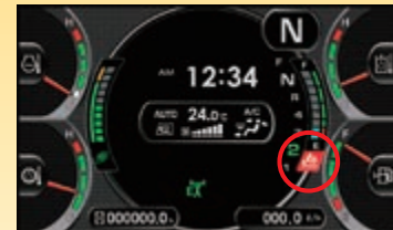
AdBlue®-Füllstandanzeige und Nachfüllhinweis
