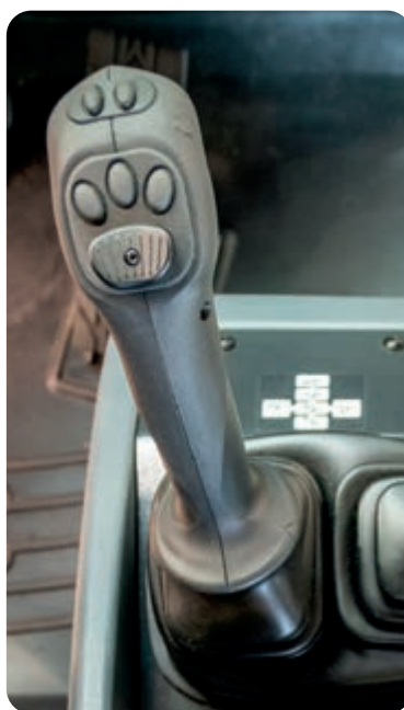
PPC-Multifunktionshebel mit optionaler elektronischer Vorsteuerung (EPC) für 3. und 4. Hydraulikfunktion
